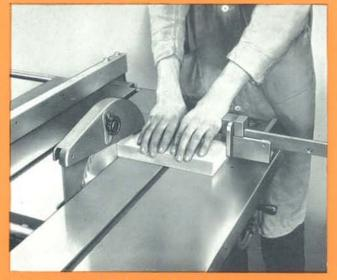
STRAIGHT CROSS CUTTING USING FIXED FENCE ON SLIDING TABLE
